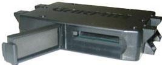
Рис. 4. Слот для карточки памяти формата Compact Flash.
