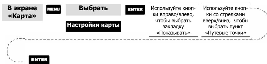
**«Включение/отключение» линии следа пути** – когда Вы передвигаетесь, след Вашего пути обычно отображается на экране «Карта» пунктирной линией. Но Вы можете «отключать» или «включать» эту функцию. По умолчанию – «включено».
