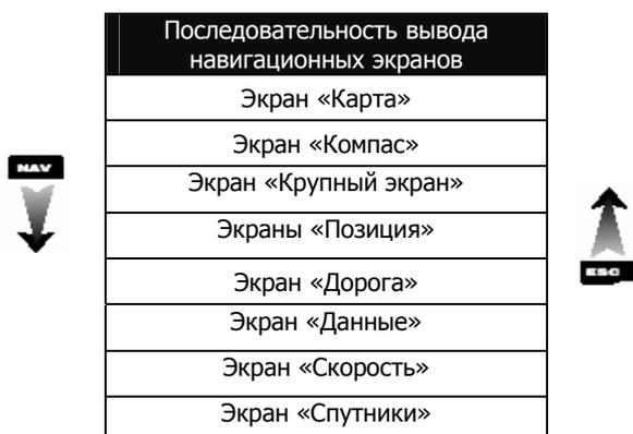
**Возвращение к навигационному экрану, просмотренному последним** – нажатие кнопки NAV приводит к выводу на дисплей навигационного экрана, просмотренного последним.
