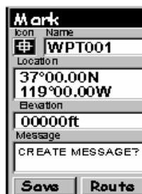
Отобразится окно выбора значка («Знак»). С помощью кнопок со стрелками выберете нужный Вам значок, имя значка выводится в верхней части экрана. В качестве справочной информации все значки и их названия перечислены в главе “Справочное Руководство”. После того как Вы выбрали значок, нажмите [ENTER].
