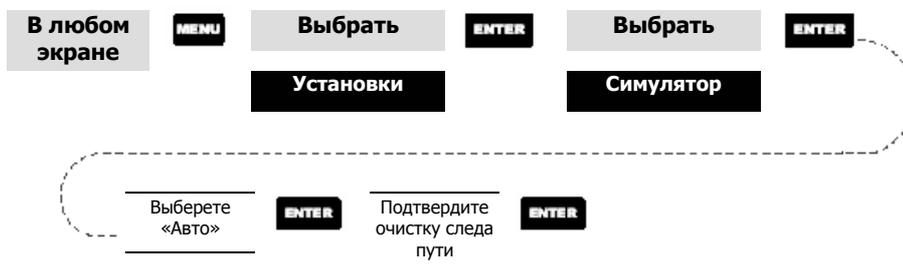
**Включение симулятора в режиме «личные»** - симулятор включается и эмулирует передвижение с курсом и скоростью, задаваемыми Вами.
