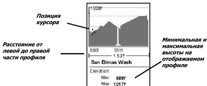
При просмотре экрана с вертикальным профилем Вы можете передвигать границы видимой части профиля, используя кнопки влево и вправо, соответственно. Вертикальная пунктирная линия в середине профиля показывает высоту точки в этой части профиля.
