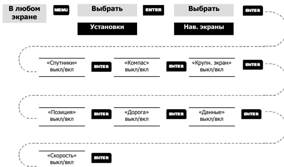
(Примечание: Чтобы внесенные Вами изменения сохранились, необходимо пройти через все навигационные экраны. Например, если Вы установили значение «Выкл.» для экрана спутники и нажали ESC до того как закончили установку для всех навигационных экранов, то внесенные Вами изменения сохранены не будут, и экран спутники будет по-прежнему находится в списке отображаемых экранов.)
