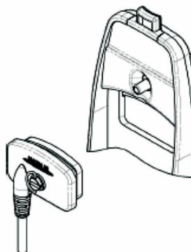
**Соединение напрямую с приемником.** С помощью винта-держателя, расположенного на разьеме кабеля, присоедините кабель к приемнику.
