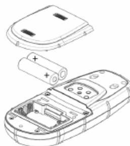
Чтобы снять защитную крышку необходимо нажать влево до упора на обе кнопки, расположенные на крышке, и поднять саму крышку. Вставьте новые батареи, соблюдая полярность, как показано на рисунке.
