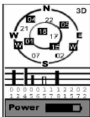
**Экран “Спутники”.** Этот экран позволяет следить за тем, какие спутники находятся в зоне видимости, и какие из них используются приемником в данный момент. Столбики показывает величину принимаемых сигналов. В нижней части экрана выводится информация о заряде батарей. Использование внешнего источника питания сопровождается соответствующим сообщением.
