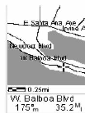
В режиме “курсор”, на экране отображается курсор, который можно передвигать по карте. В нижней части экрана теперь отображается информация о местоположении курсора относительно Вашего текущего местоположения, а также названия географических пунктов, рядом с которыми находиться курсор.
